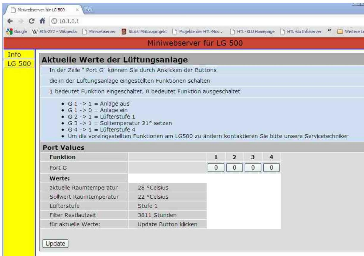
Um aktuelle Werte angezeigt zu bekommen, müssen diese Daten erst einmal über den Datenbus, der das Bedienteil mit dem LG500 verbindet, gesendet werden.
